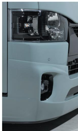
純正バンパーに被せるタイプのバンパースポイラー。前方への突出を最小限に抑えながら、フォグ周りの深みを出しコの字ラインで存在感を強調。バンパー上部のラインをあえて斜めに上げることで、他にはない印象を作り出す。純正のバンパーを残すことで、クリアランスソナーを触ることなくカスタマイズ可能。ナンバープレート後ろのダクトラインに、別パーツのABS製のブラックアウトパネルを取り付けることで開口部を大きく魅せる効果がある。別パーツで脱着可能にすることで、純正バンパーの牽引フックを使うことができるようにした。ステップ部にもサイドステップへつながるプレスラインを作り、シンプルながら最大限にアクセントを設けている。
