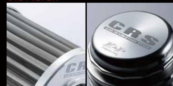
フィルターには医療用にも採用される35ミクロンの穴を均等に並べた「304ステンレスフィルター」を採用。ステンレス製のフィルターはオイルを吸収せず、また熱による膨張率も均一なため、一般的な「紙繊維製フィルター」に対し、約7倍の透過効率を実現し、循環効率を最適化することで冷却効率をアップさせています。フィルタ底部には「ネオジウムレアース磁石」も搭載するため、強力にスラックを捕らえ、大事なエンジンを守ります。またトップ部分には緊急時用ワンウェイバルブを装備。万が一何らかの理由でフィルター面が完全に目詰まりを起こしてしまってもオイルの潤滑は止まらず、エンジンブローを防止します。
