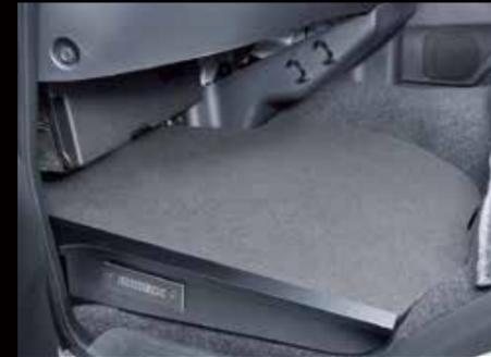
■ FOOT UP FLOOR PANEL ■ 助手席フットアップフロアパネル
