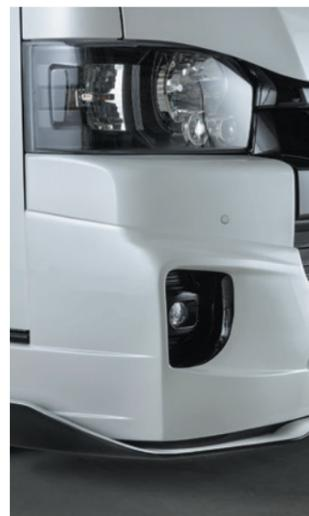
純正バンパーに被せるタイプのバンパースポイラー。前方への突出を最小限に抑えながら、フォグ周りの深みを出しコの字ラインで存在感を強調。バンパー上部のラインをあえて斜めに上げることで、他にはない印象を作り出す。純正のバンパーを残すことで、クリアランスソナーを触ることなくカスタマイズ可能。ステップ部にもサイドステップへつながるプレスラインを作り、シンプルながら最大限にアクセントを設けている。
