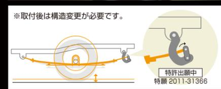
S字構造のシャックルによるリフト式インクがリヤの突き上げを
