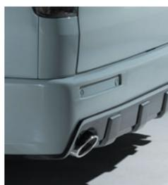
純正リアバンパーに被せるタイプのバンパースポイラー。ブロック状のデザインにすることで、アゲ仕様にもサゲ仕様にも似合う。クリアランスソナー開口部をあえて大きなスクエア型にして、目立たせながらもシンプルなデザインにしている。リアサイドビューはフロントからサイドへ、そしてリアへ繋がる自然なプレスライン。さらにリアサイド下側から後ろへと立ち上がっていくハの字のプレスラインが立体感のあるデザインを演出する。純正リアバンパーに被せるエアロの為、純正ステップがそのまま使える「タイプステップ」も設定あり。マフラー開口部も右出し、W出しが選べる。デモカーはタイプステップレス、マフラーW出し仕様。
