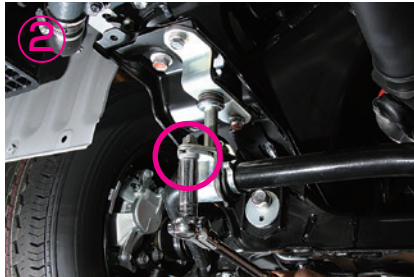
②~⑤純正のスタビ固定ブラケットを外して下さい
