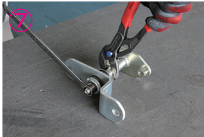
⑦~⑩Z型スーから純正品を外し、本商品と交換して下さい。ブッシュの締め付けはネジが1~2山出る程度にして下さい。
