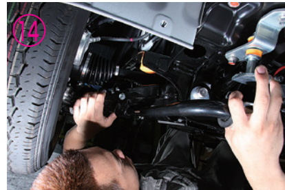
⑦~⑩Z型スーから純正品を外し、本商品と交換して下さい。ブッシュの締め付けはネジが1~2山出る程度にして下さい。
