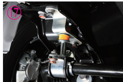
⑮~⑰逆の手順で取り付けていき、最後に全てのネジが緩んでいないかチェックし、完成です。
