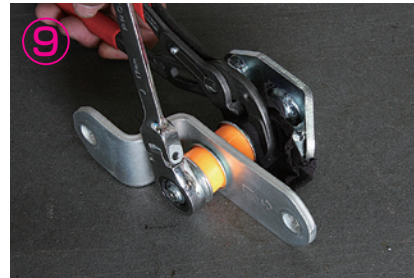
⑦~⑩Z型スーから純正品を外し、本商品と交換して下さい。ブッシュの締め付けはネジが1~2山出る程度にして下さい。
