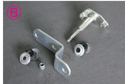
⑦~⑩Z型スーから純正品を外し、本商品と交換して下さい。ブッシュの締め付けはネジが1~2山出る程度にして下さい。
