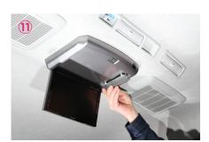
その後 ナベボルトでモニター本体を取り付け、キャップを閉めれば完成です。
