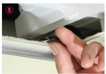
スピードナットをはめて、6X10 六角ボルトを仮止めして下さい。
