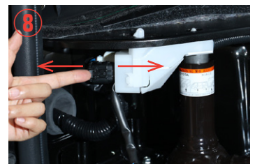
⑧～⑩ 接続されているケーブルを外し、本商品を間に 割り込ませて下さい。 (2カ所)
