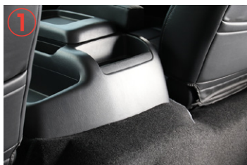
①～⑤ センターコンソールBOXを取り外して下さい。
