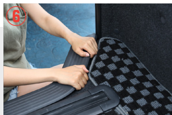
⑥・⑦ スライドドアステップを取り外して下さい。
