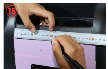
⑯～⑲ 先の手順で取り外したセンターコンソールBOXに印を付けて下さい。 (⑲図参照)
