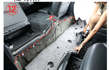
⑪～⑭ エンジンルームカバーを外して、先に接続した 本商品の配線をセンターコンソール部分まで まわして下さい。
