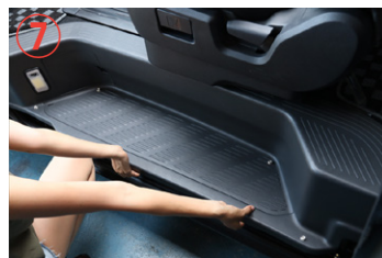
⑥・⑦ スライドドアステップを取り外して下さい。
