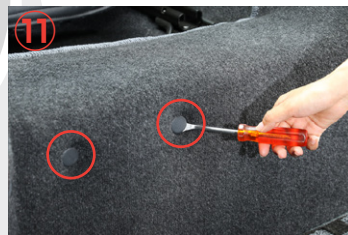
⑪～⑭ エンジンルームカバーを外して、先に接続した 本商品の配線をセンターコンソール部分まで まわして下さい。
