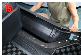
⑮ スライドドアステップを 戻して下さい。
