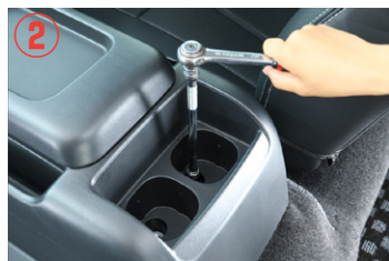
①～⑤ センターコンソールBOXを取り外して下さい。
