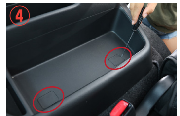
(細い⊕ドライバー等で、 キャップを外して下さい)
