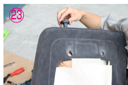
⑰～⑱シート背面のカバーを取り外して下さい。
