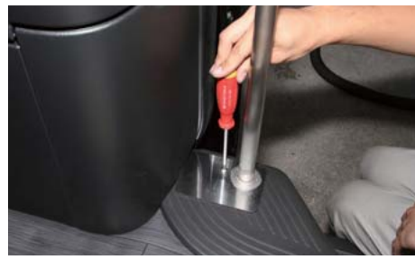
ステップを戻しフレームを合わせ、5mm ボルトで固定する
