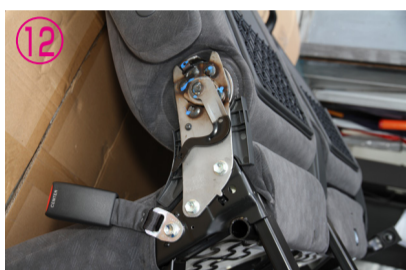
⑦～⑨3型後期以降の車輻は通路側シートのシートベルトを外して下さい。
