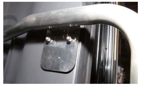
最後にCピラー部分を袋ナットで固定する
