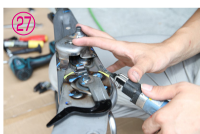
⑳～㉓リクライニングのストッパーとなる○部分をサンダーやエアソー等でカットして下さい。
