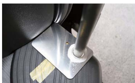
フレーム上部が先ほどのCピラー固定金具にしっかりと当たった状態で脚位置を決める
