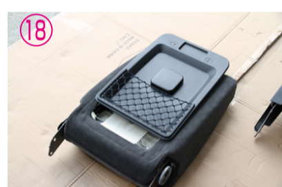
⑰～⑱シート背面のカバーを取り外して下さい。
