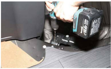
ステップを外し先ほどにマーク部分にΦ9mmの穴をあける
