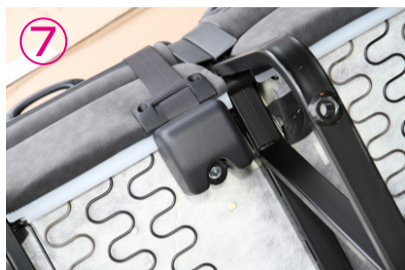
⑦～⑨3型後期以降の車輻は通路側シートのシートベルトを外して下さい。
