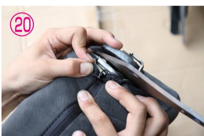
⑲～⑳シート表皮を外し、ウレタン部分ごとシートフレームと分離して下さい。
