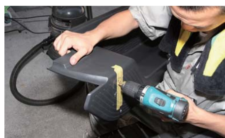
ステップを外し、Φ6mmの穴をあける
