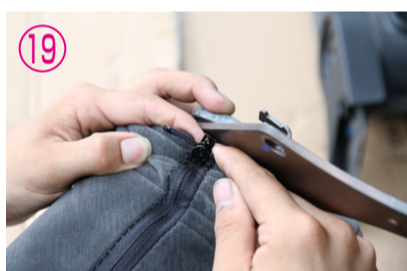
⑲～⑳シート表皮を外し、ウレタン部分ごとシートフレームと分離して下さい。
