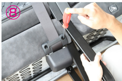
⑦～⑨3型後期以降の車輻は通路側シートのシートベルトを外して下さい。
