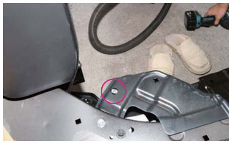
付属の5mm ターンナットをはめ込む
