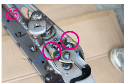
⑳～㉓リクライニングのストッパーとなる○部分をサンダーやエアソー等でカットして下さい。
