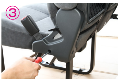
①～⑥シートを車輻より取り外し、リクライニングレバーのカバーを外して下さい。
