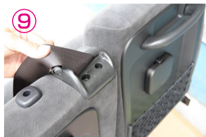
⑦～⑨3型後期以降の車輻は通路側シートのシートベルトを外して下さい。
