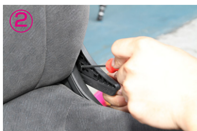
①～⑥シートを車輻より取り外し、リクライニングレバーのカバーを外して下さい。
