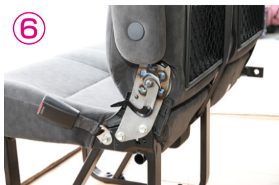
①～⑥シートを車輻より取り外し、リクライニングレバーのカバーを外して下さい。
