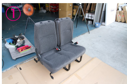
①～⑥シートを車輻より取り外し、リクライニングレバーのカバーを外して下さい。
