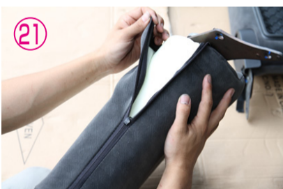
⑲～⑳シート表皮を外し、ウレタン部分ごとシートフレームと分離して下さい。
