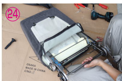
⑲～⑳シート表皮を外し、ウレタン部分ごとシートフレームと分離して下さい。
