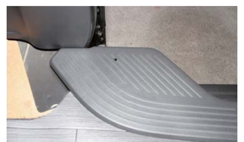
一度ステップを戻し、その下の鉄板に穴位置をマークする
