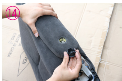
⑭アームレストがある部分は取り外して下さい。
