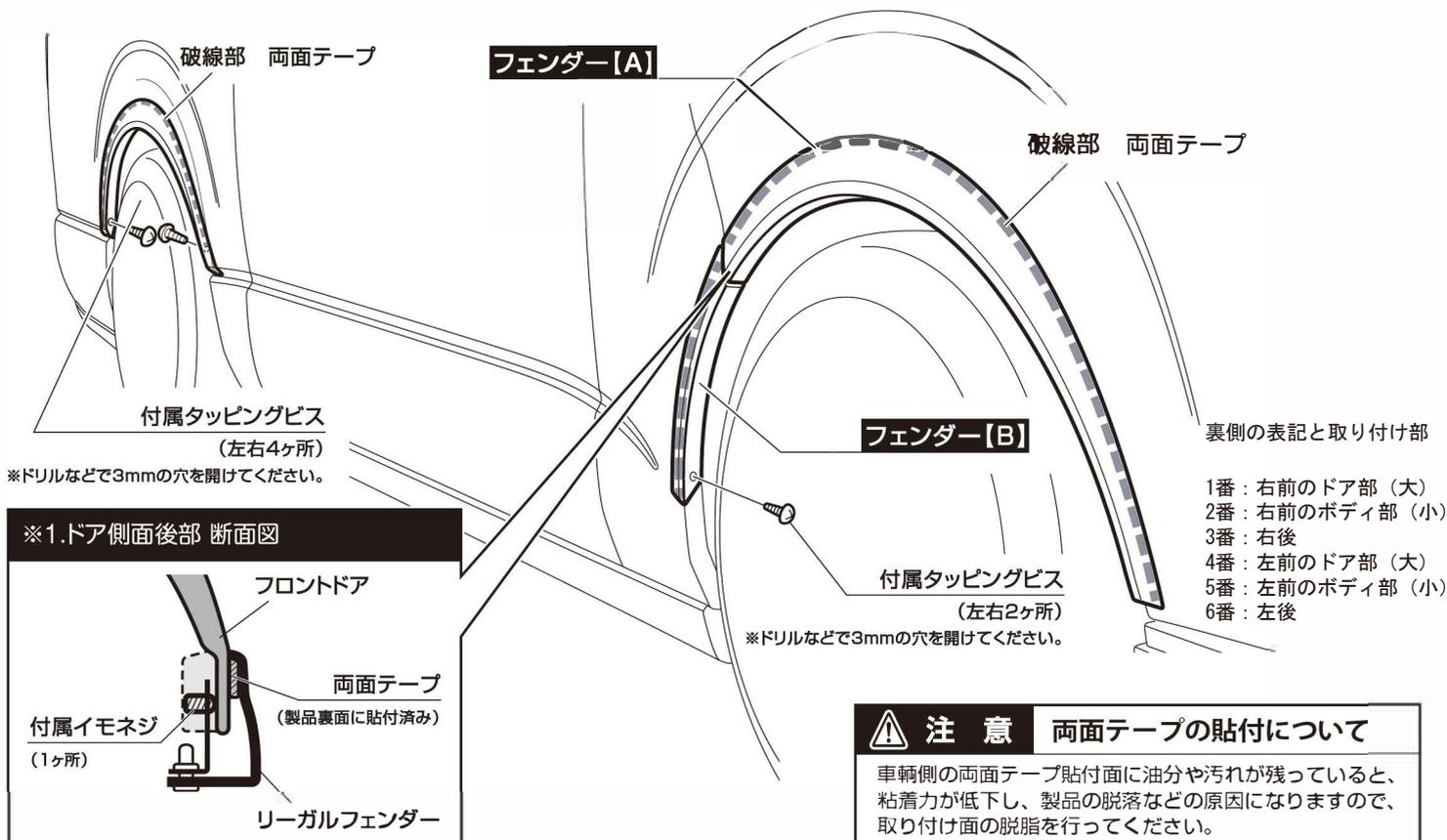
● 取付け終了後は、ネジ等の締め付け及び全体のガタツキ等がないか、もう一度確認して下さい。 ● 一定期間ごとの増し締め作業を必ずお願いします。
