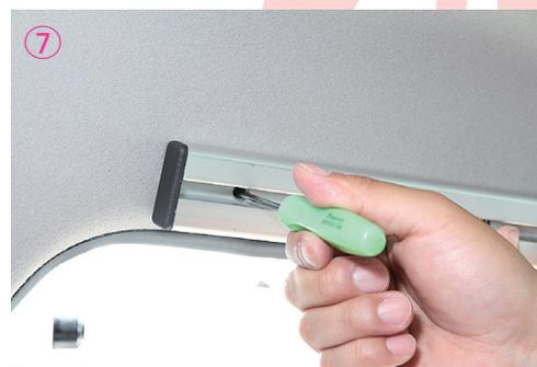
5. フロントレール取付土台の中央穴を6x30mmボルトで固定して下さい。
